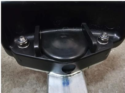
Anschließend die M6 Unterlegscheiben klein auflegen und die M6 Stoppmuttern anziehen. Wenn notwendig den Montagekopf am Schlitten ausrichten und die Schrauben festziehen.
