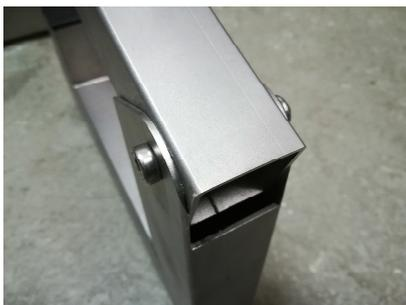
Die Hebelachse wird mittels der M8 Innensechskantschraube mit der Traverse lang am Gelenkpunkt verschraubt. Stecken Sie die M8 Innensechskantschraube von links durch die Löcher der Traverse lang und der Hebelachse. Achten Sie darauf das die Rastmarke an der Hebelachse (Endpunkt beim Einstecken der Hebelverlängerung) nach unten zeigt.
