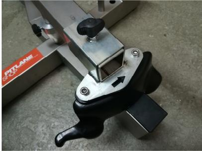
Die beiden M6 Innensechskantschrauben werden von oben durch die Montageplatte am Schlitten und den Montagekopf selbst gesteckt.
