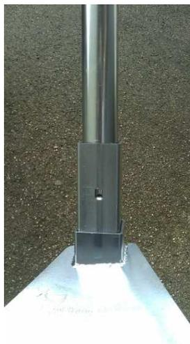
Nut und Feder müssen beim Zusammenstecken fluchten. Nur so steckt die Verlängerung weit genug in der Aufnahme. Dadurch wird ein Verdrehen der Verlängerung verhindert und eine optimale Kraftübertragung gewährleistet.
