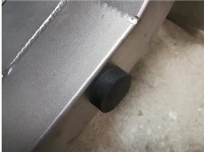
Die fünf GummifüÙe mit M8 Gewindestift werden von unten in die entsprechenden M8 Gewindelöcher der Traverse kurz (2 Stk.) und der Traverse lang (3 Stk.) eingeschraubt. Anschließend können die GummifüÙe mit einer geeigneten Zange und Gefühl fest nachgezogen werden.
