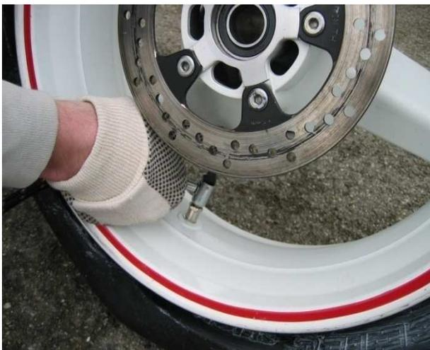
Der Reifen wird nun mit ca. 3-4 bar aufgepumpt (ohne Ventileinsatz), damit der Reifen vollständig auf das Felgenbett rutscht. Das wird akustisch mit zwei lauten « Peng » Geräuschen angezeigt.
