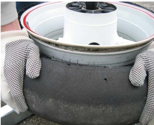
Der Reifen wird etwas gedreht und man wiederholt den Vorgang solange, bis sich der Reifen von der Felge vollständig gelöst hat (Natürlich auf beiden Seiten).
